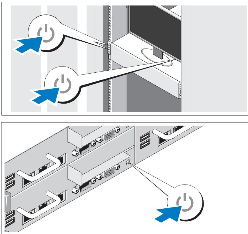
Appuyez sur les boutons d'alimentation à l'avant ou à l'arrière du système et du moniteur. Les voyants d'alimentation s'allument.
